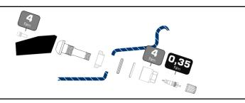
Der Standard Ventilschaft für den Alligator Universalsensor ist Typ H03. Für bestimmte Felgenformen kann ebenfalls Typ H04, Typ H05 oder Typ H06 genutzt werden. Der Unterschied liegt lediglich in der Länge des Ventilschaftes.
