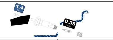
Gummi-/ Metallventil formschlüssig an Sensor montieren.
