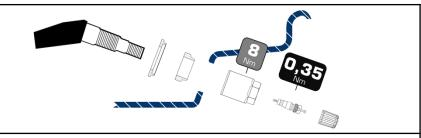
$\label{thm:continuous} \mbox{Unterlegscheibe und Gummidichtung mit dem breiten Durchmesser formschlüssig in Richtung Sensor montieren.}$
