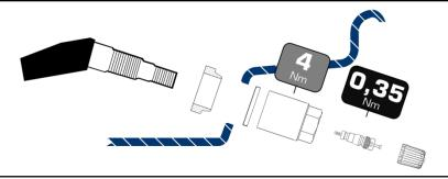
Die Gummidichtung formschlüssig mit dem breiten Durchmesser in Richtung Sensor montieren.
