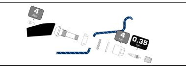
Der Standard Ventilschaft für den HUF Universalsensor ist Typ H03. Für bestimmte Felgenformen kann ebenfalls Typ H04, Typ H05 oder Typ H06 genutzt werden. Der Unterschied liegt lediglich in der Länge des Ventilschaftes.
