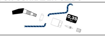
Die Gummidichtung formschlüssig mit dem breiten Durchmesser in Richtung Sensor montieren.
