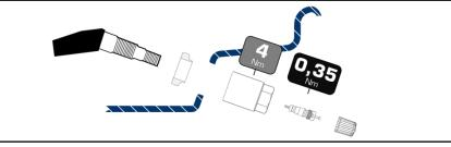
Die Gummidichtung formschlüssig mit dem breiten Durchmesser in Richtung Sensor montieren.
