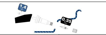
Gummiventil formschlüssig an Sensor montieren. Bitte das korrekte Drehmoment beachten.
