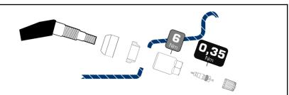
Die Hülse am unteren Teil des Ventilschaftes muss formschlüssig am Sensor positioniert werden. Damit kann der Winkel des Sensors an die jeweilige Felge angepasst werden.
