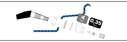
Gummidichtung formschlüssig mit dem breiten Durchmesser in Richtung Sensor montieren.
