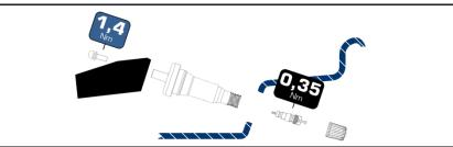
Am unteren Messingschaft befindet sich kein Gewinde, da eine selbstschneidende Schraube verwendet wird. Bitte das korrekte Drehmoment von 1,4Nm beachten.
