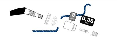
Die Abschrägung an der Unterlegscheibe (1) muss zur Sensorunterseite zeigen. Die Gummidichtung (2) formschlüssig mit dem breiten Durchmesser in Richtung Sensor montieren.
